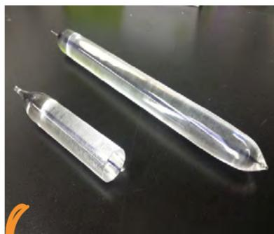
La fibre optique est créée à partir d'un tube appelé « préforme ». Ce tube est chauffé à 3 200 °C pour former une « goutte » qui est étirée sur 20 m pour devenir le fil de fibre optique !
